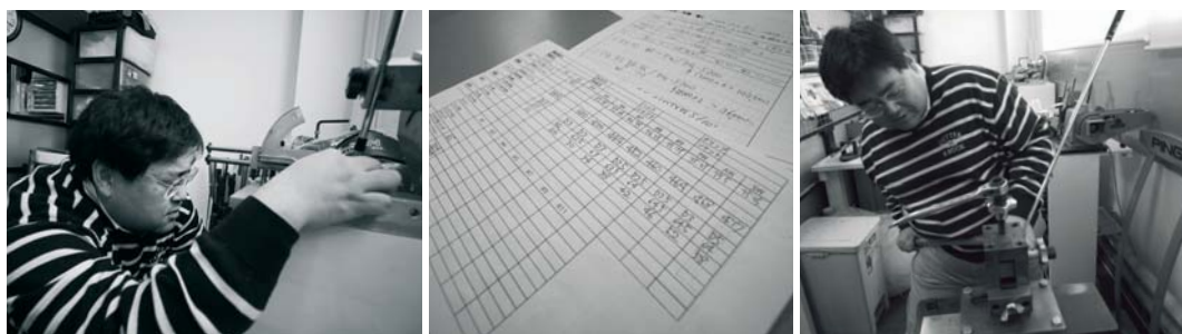
左:店の奥には作業スペースがあり、仕入れるすべてのクラブはここで検品する。中:顧客のスイングやクラブのデータが細かく記入された、カルテのようなもの。右:特殊な機械でクラブのライ角調整をする北市。
